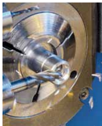
Monolitní karbidová fréza CHATTERFREE s variabilní zubovou roztečí
