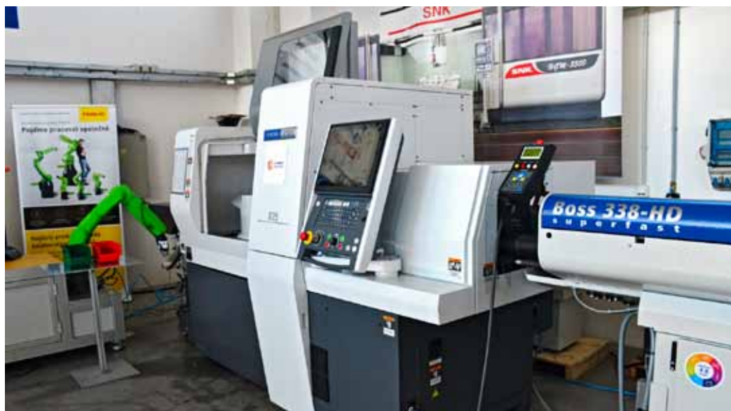
Obr. 2: Robotická buňka - CNC soustružnický automat CITIZEN Cincom D25-1M8 + robot Fanuc + měřicí stanice Renishaw Equator
