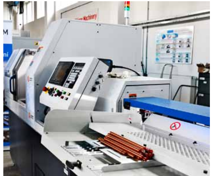
Obr. 4: CNC soustruh CITIZEN Cincom L20E-2MD se zásobníkem tyčí lemca KID 80+ a zařízením pro zpracování konců tyčí
