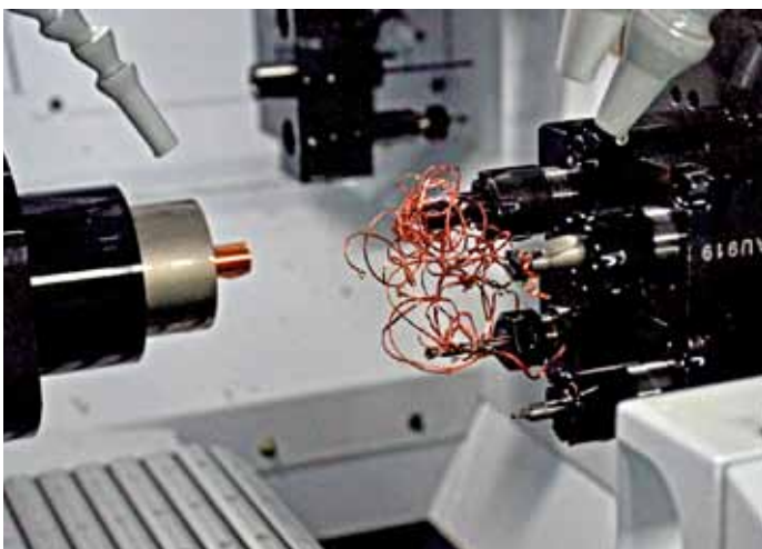
Obr. 5: Dlouhé třísky při obrábění mědi na stroji CITIZEN Cincom L20E-2M10; LFV deaktivováno
