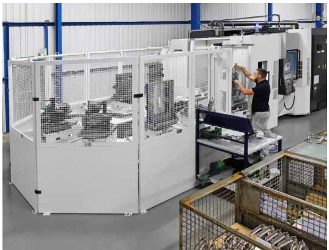
Obr. 4: Zásobník palet včetně nakládacího místa se strojem MB 5000H
