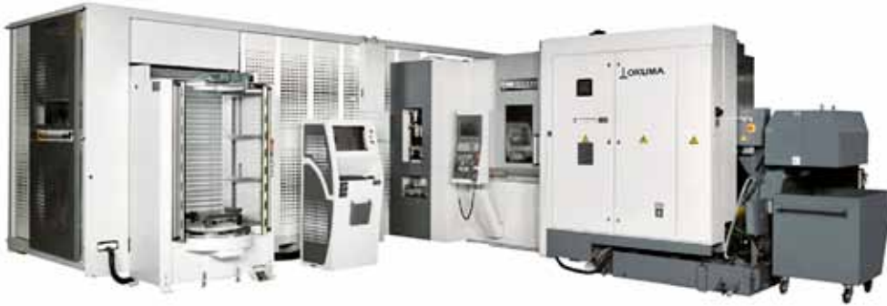
Obr. 5: Skříňový zásobník palet Palletace se strojem Okuma MB 5000H
