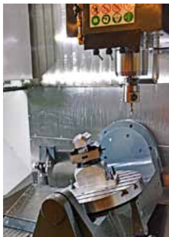
Obr. 4: Pracovní prostor obráběcího centra Haas UMC-750SS
