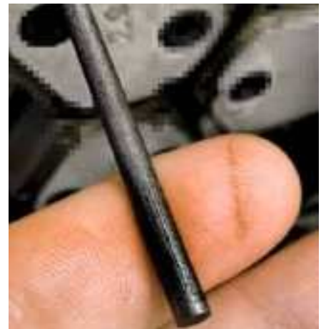
Obr. 4: Poškozený vyhazovač po několika cyklech
