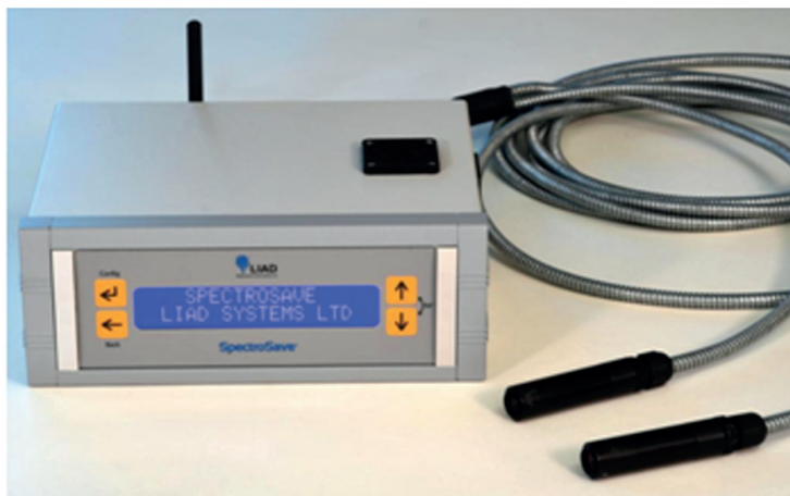
Obrázek 7 – Řídící jednotka SpektroSAVE a sondy
