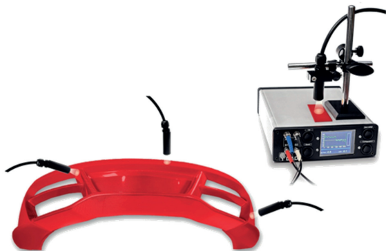
Obrázek 8 - vícekanálové měření rozměrných dílů
