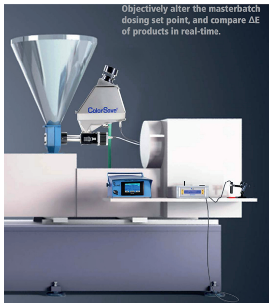
Obrázek 9 - vložení systému SpektroSAVE do výrobní linky
