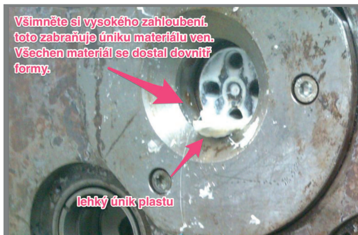
Obrázek 7 - Příliš hluboké středění může být příčinou zatékání plastu do formy okolo vstříkovací objímky
