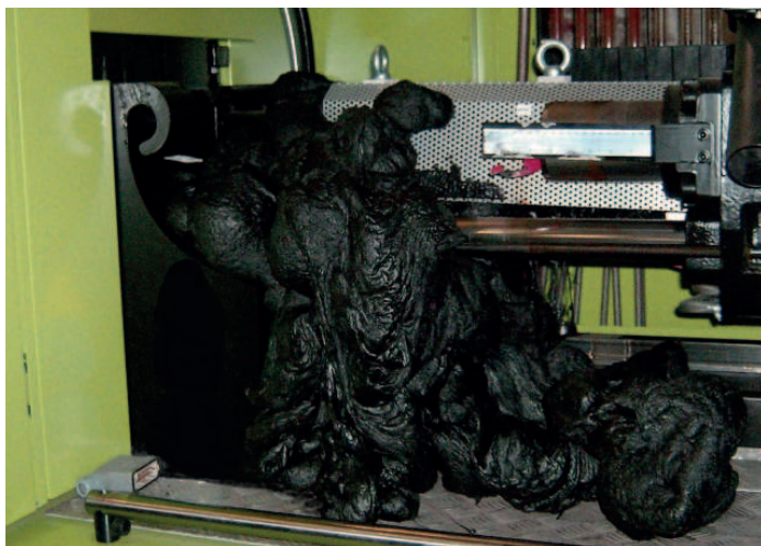
Obrázek 2 - masivní únik materiálu okolo špičky šneku na noční směně
