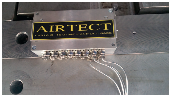
Obrázek 17 - sensorové trubičky a fixní část rozvaděče jsou nedílnou součástí formy
