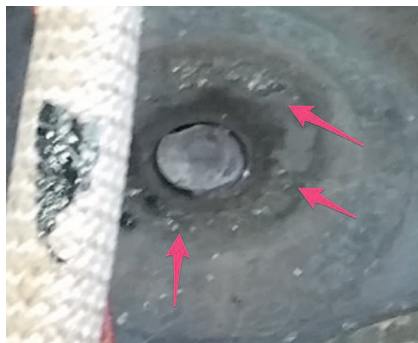
Obrázek 14 - kavitace vzniklá zatlačením podložek
