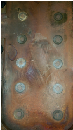
Obrázek 11 - vtlačení podložek do desky
