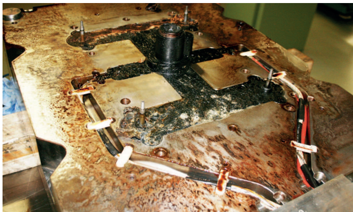
Obrázek 1 - zatečený horký systém - noční můra všech lisoven
