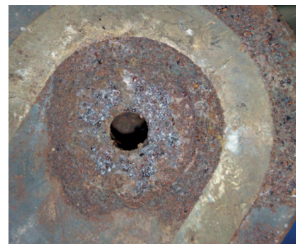
Obrázek 16 chemická koroze vlivem uvolňování aditiv z plastu – v tomto případě byl problém nedodržení technologických podmínek a rozklad plastu v horkém systému
