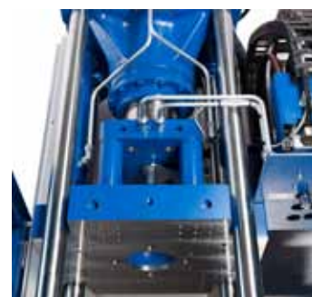
Centrální hydraulický uzavírací systém stroje SmartPower
