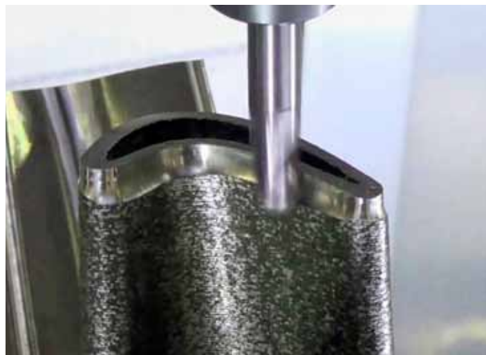
Kombinací nanášení a obrábění na jedno upnutí mohou být vytvořeny a třískově dokončeny složité tvary s maximální přesností
