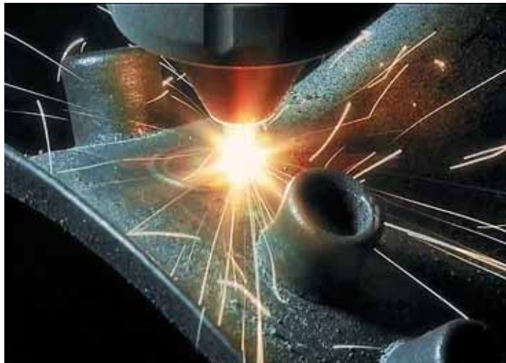
Nanášení materiálu na víceosém obráběcím centru umožňuje dotváření konstrukce pod libovolným náklonem, čímž lze docílit rychlejší a flexibilnější tvorby dílu
