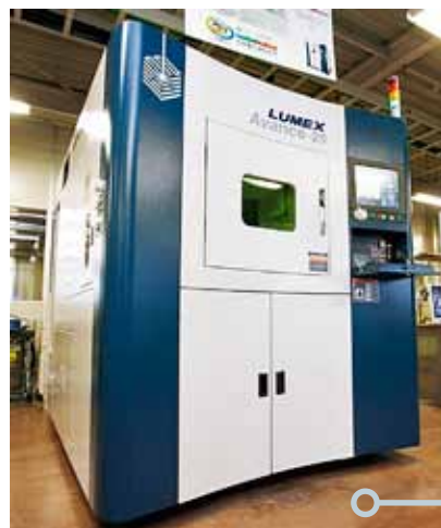
Hybridní stroj LUMEX Avance-25 od společnosti Matsuura v sobě spojuje technologie výběrového laserového spékání (SLS) a vysokorychlostního frézování
