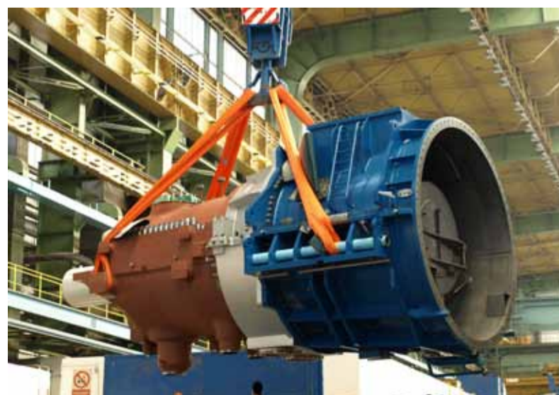
Převážení sestaveného ST-NT dílu turbíny - je požadována rychlá montáž na elektrárně; hmotnost přepravované části 146 tun
