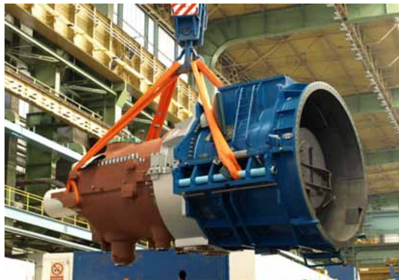
Přeprava sestaveného ST-NT dílu turbíny – je požadována rychlá montáž na elektrárně; hmotnost přepravované části 146 tun
