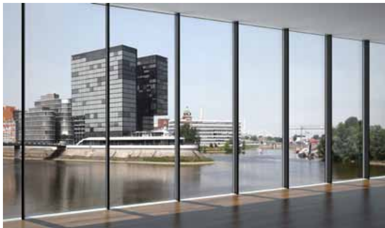
Fasádní systém Schüco FWS 35 PD pro prosklené opláštění
