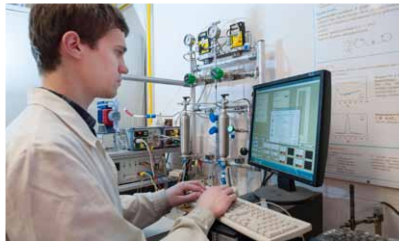
Laboratorní jednotka pro rozklad vody elektrolýzou s využitím protonově vodivé polymerní membrány
