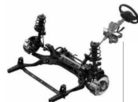
Přední náprava vozu typu McPherson využívá pomocný rám a řízení pracuje s elektrickým posilovačem
