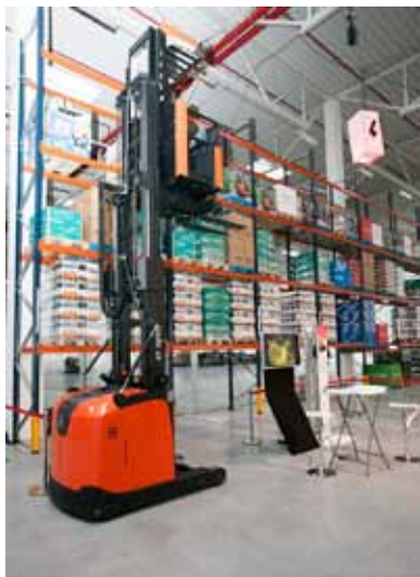
Model BT SPE160 navíc nabízí nejvyšší zústatkové nosnosti ve své třídě - až 660 kg ve výšce 6 metrů
