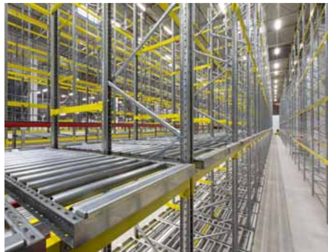
Linde Material Handling dodává regálové systémy - příklad spádového regálu
