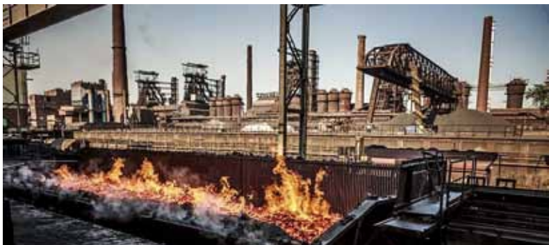
Čerstvě vyrobený koks po vytlačení z koksárenské baterie dosahuje teploty 1100 °C a na vzduchu začíná ihned hořet
