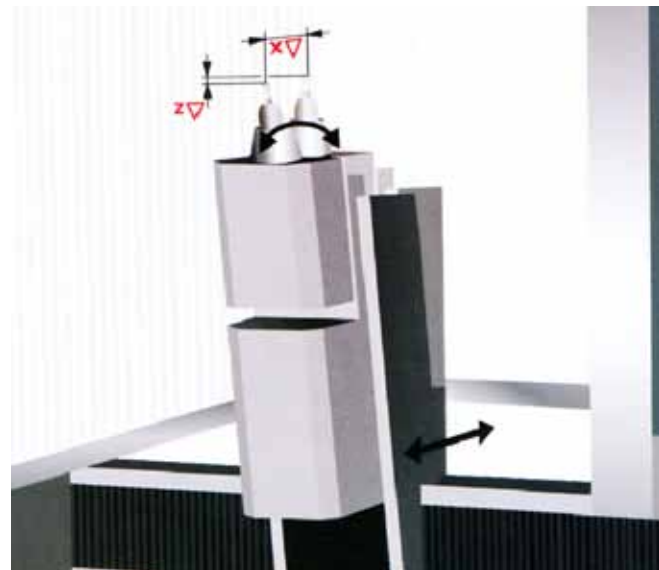
Obr. 4: Změna polohy špičky nástroje způsobená dynamikou pohybu stroje
