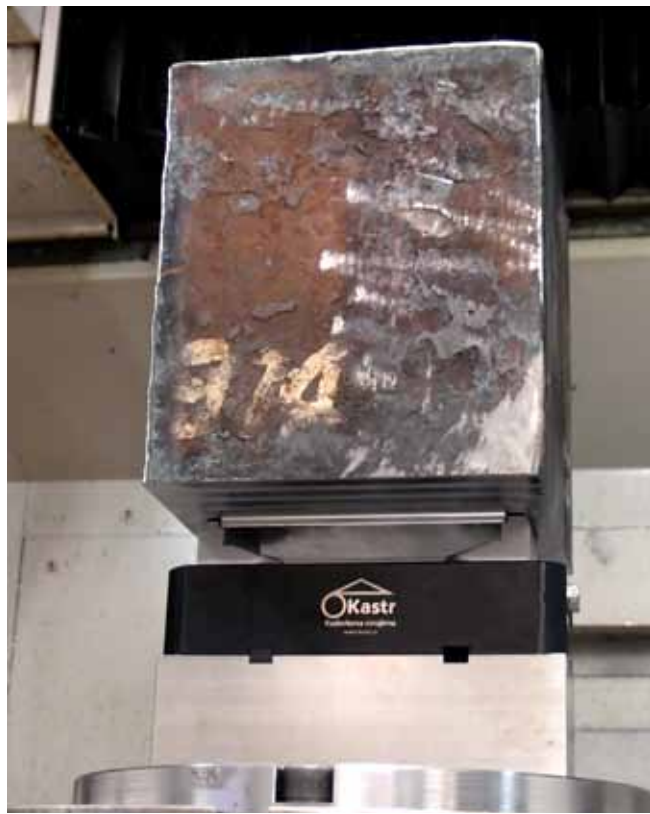
Stokilogramový polotovar upnutý za 3 mm do tvrdých čelistí při vyložení 240 mm z upínače
