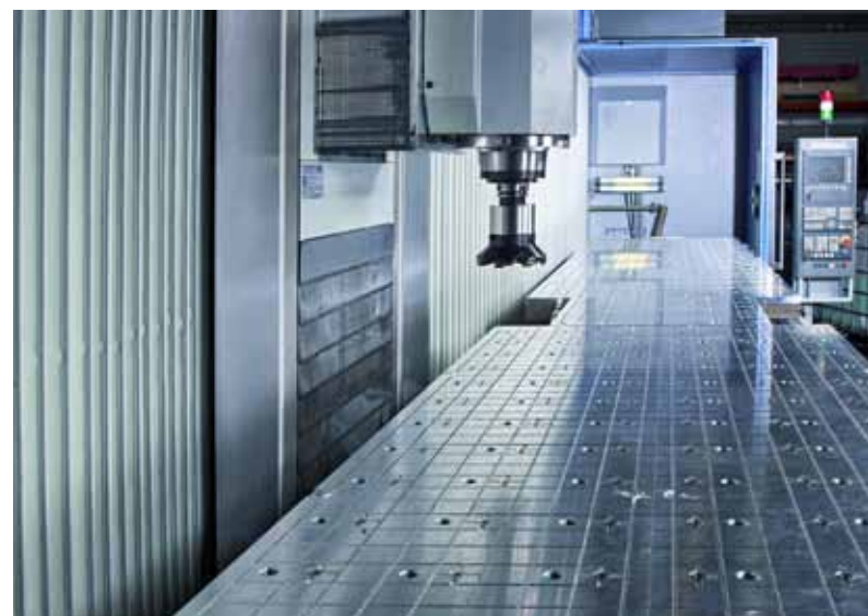
Kombinací matričních desek mohou být - jak je vidět na tomto obrázku z letecké konstrukce - upínány i dlouhé hliníkové díly bez deformací
