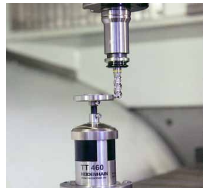
Obr. 6: Dotyková sonda HEIDENHAIN TT460 pro měření nástrojů
