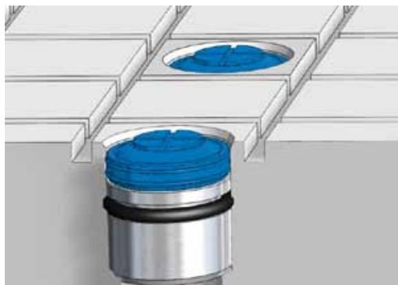
Spatentovanými třecími ostrůvky PLANOS vzrůstají horizontální přídržné síly až o 30%. Jsou aktivovány automaticky pomocí vakua (aktivní / neaktivní)
