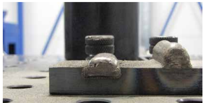
Ulomený zub hřebenu lze znovu vytvořit díky laserovému navařování prášku
