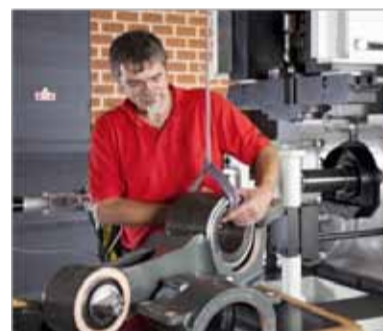
Na zkušebním zařízení ve Schweinfurtu se zkouší především dvořadová kuželíková a válečková ložiska v originálních tělesech. Před testováním se ložiska (zde dvořadová kuželíková ložiska) namontují do nápravové skříně
