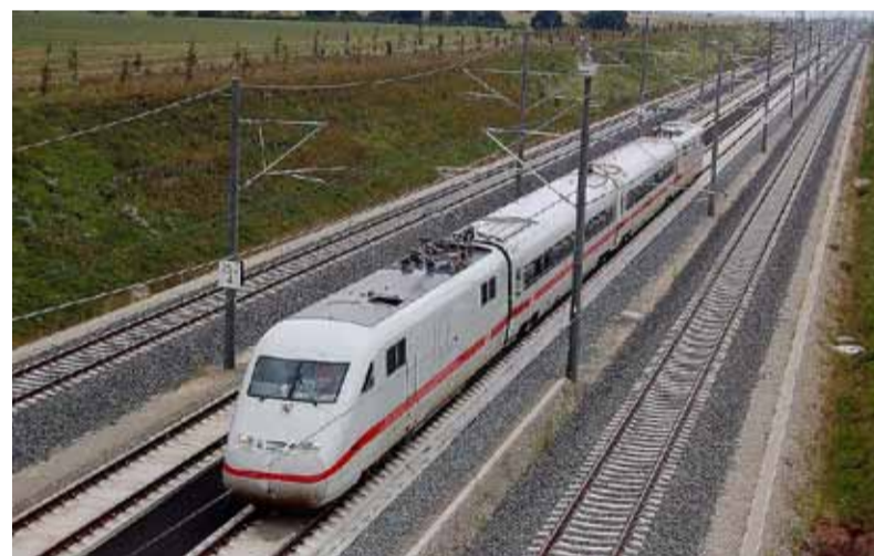
Testovací jednotka ICE-S v úseku Jüdendorf - Lipsko bude na podzim prověřovat trať rychlostí až 330 km/h
