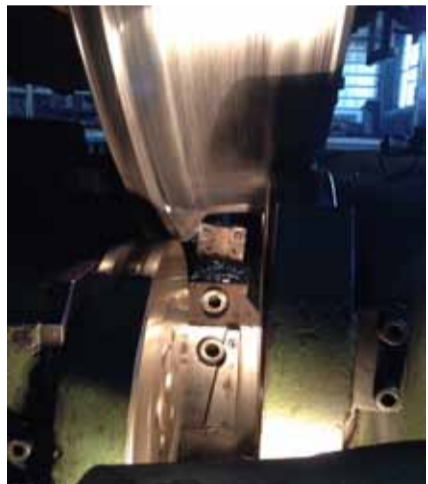
Renovace kola na podúrovňovém soustruhu
