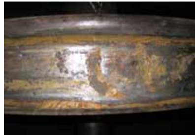
Vytrhaný materiál (shelling)
