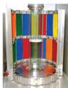
Obr. 2: Rotační Q-SUN XE2, detail uložení vzorků kolem lampy obklopené filtračním systémem
