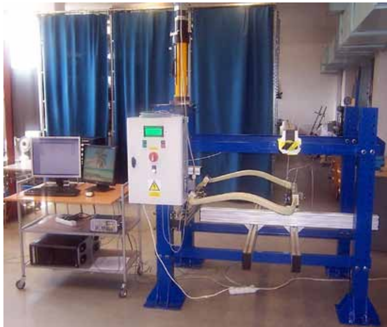
Univerzální zatěžovací systém pro testy tuhosti a pevnosti vyztužených kompozitních soustav
