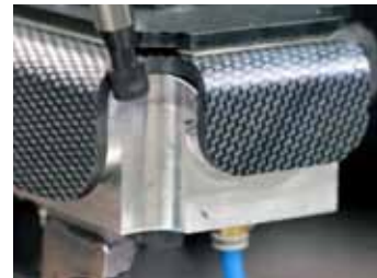
Obr. 3: Konkrétní aplikace - 3D ořez kompozitového dílce na pětiosém obráběcím centru
