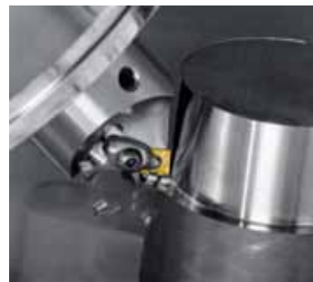
Obr. 2: Pracovní prostor obráběcího centra Integrex s výklopnou pracovní hlavou
