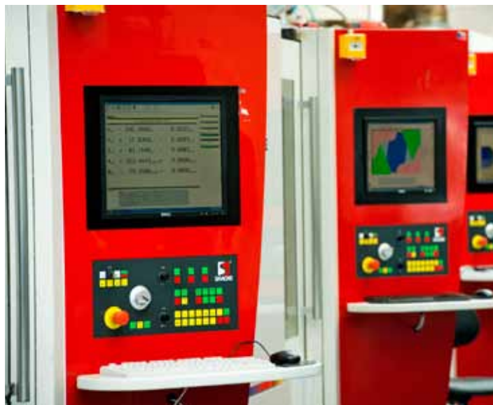
Jádrem strojních kapacit je soubor pětiosých nástrojových CNC brusek Saacke s veškerým aktuálním softwarem
