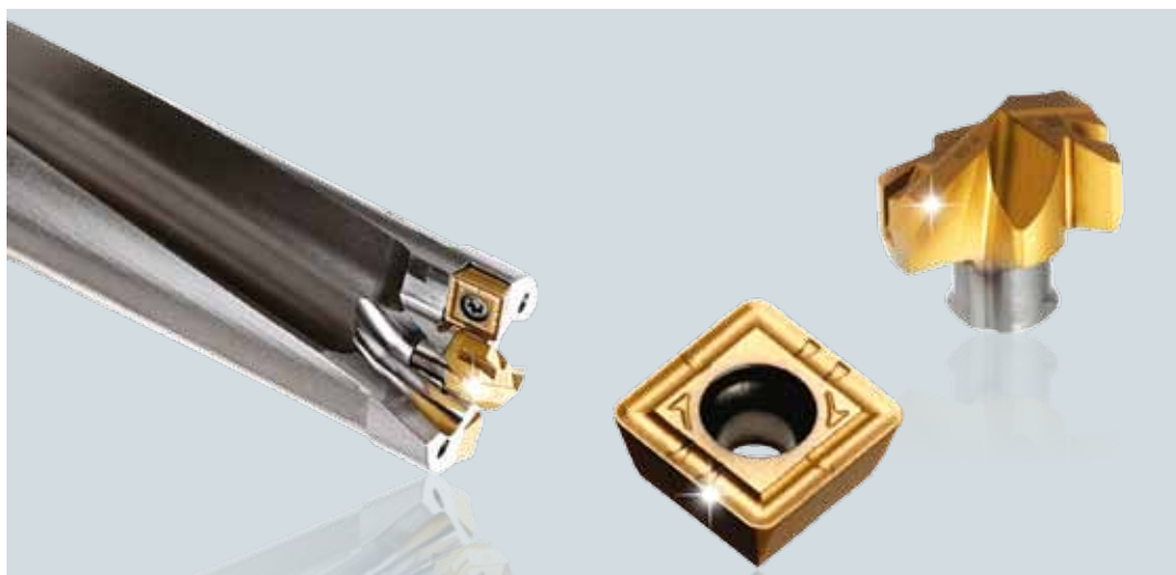
Obr. 6: Vrták TwinRush s výměnnou hlavici Drill Rush a dvojicí čtvercových VBD
