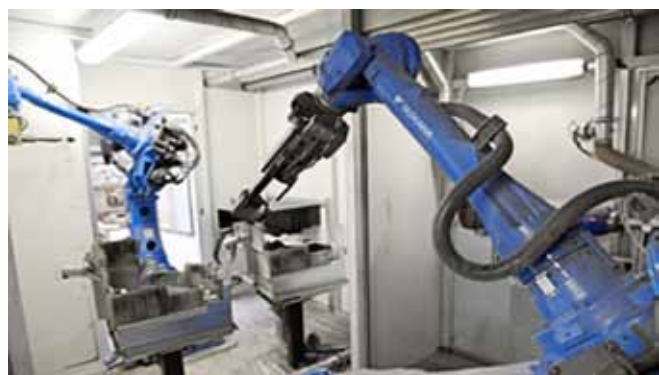
Dva roboty Motoman od firmy Yaskawa se vyznačují naprostou spolehlivostí, a to i v prostředí s velkým množstvím brusného prachu
