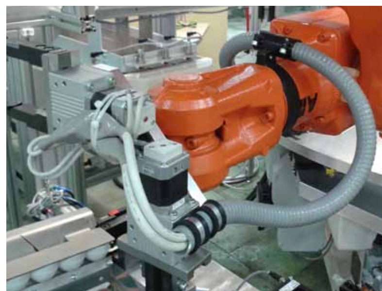
↑ Realizace: přípravek se dvěma elektrickými úchopnými hlavice pro vnitřní i vnější úchop
