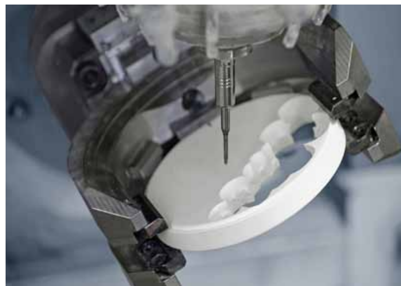
Stejně jako zde, při frézování zirkonu, dokazuje polygonální upínací technika TRIBOS i v oboru dentální techniky maximální přesnosti
