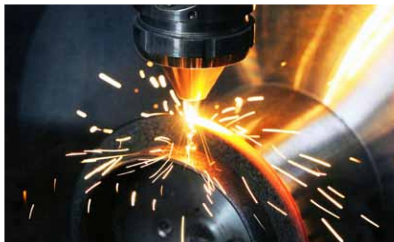
Obr. 3: Vytváření struktury laserovým navařováním na stroji DMG MORI Lasertec 65 3D
