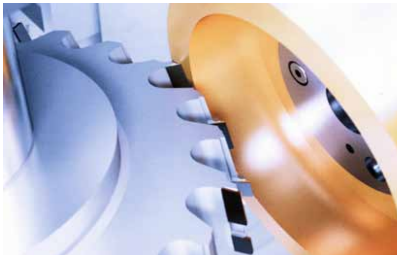
Obr. 4: Erodování řezného nástroje, osazeného PKD na stroji Vollmer QXD 250
