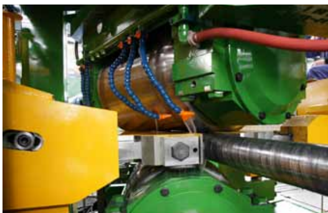
Dvouválcová rovnačka na tyčový materiál XRK 2-180 uvedená do provozu v Číně (2013). Rozsah rovnacích průměrů: 75-180mm, délka tyčí 4-12 m, max. mez kluzu 1100 MPa, max. rychlost rovnání 60 m/min
