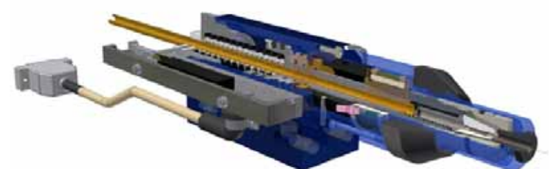
Nýtovací hlava na trhací jednostranné nýty vybavená kontrolou procesu
