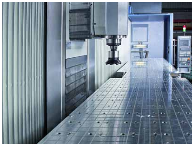
Kombinací matričních desek mohou být - jak je vidět na tomto obrázku z letecké konstrukce - upínány i dlouhé hliníkové díly bez deformací
