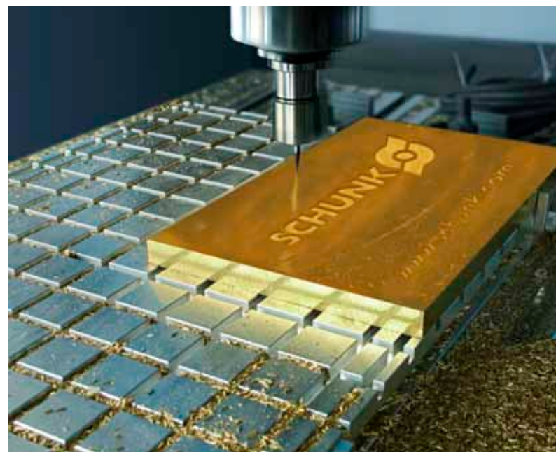
Na upínací desku PLANOS se upínají ploché obrobky jednoduše, rychle a bezpečně pomocí podtlaku
