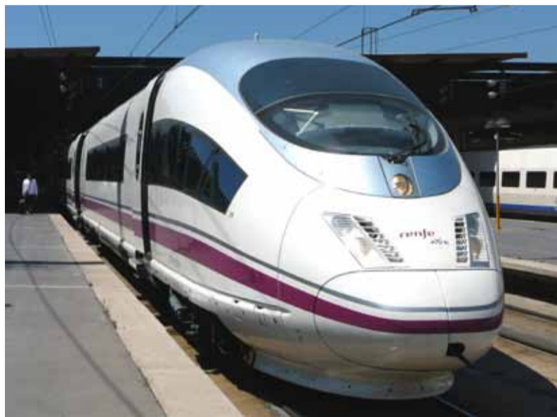
Na španělských drahách RENFE mohou nejrychlejší soupravy Velaro-E od Siemensu s motory o 8800 kW dosáhnout rychlosti až 350 km/h (Foto Siemens)
