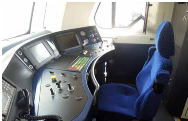
Strojvedoucí RegioPanterů mohou sledovat nástupišť pomocí kamer (Foto Škoda Transportation)
