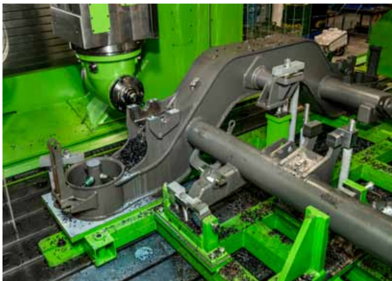
← ↑ Příklad zákaznického řešení - obrábění podvozku
