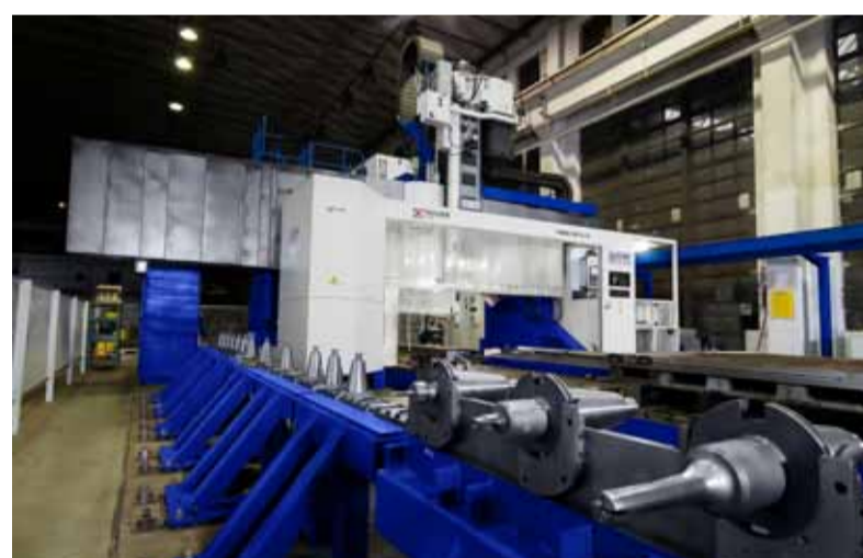
Portálové obráběcí centrum pracující v KZN Biezanów
