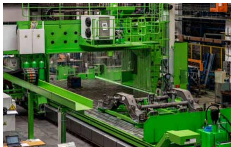
← ↑ Příklad zákaznického řešení - obrábění podvozku
