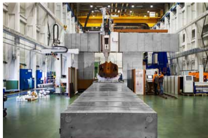
Obrábění dieselového motoru na stroji FRPFQ
