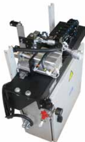
Systém SKF pro mazání řetězů plastickým mazivem - použití v cukrovaru
