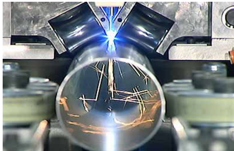
Vedení trubky při podélném svařování
