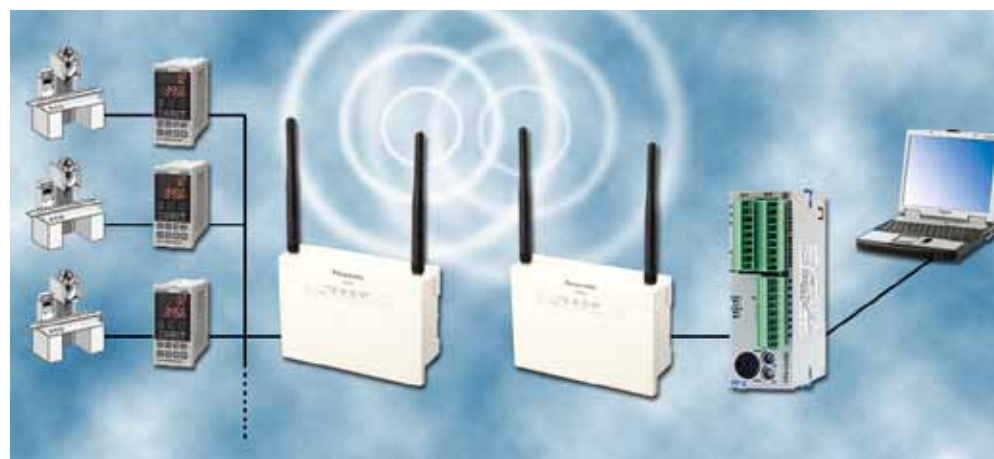
Celkem 250m bezdrátového přenosu dokáže ušetřit vícenásobky s kabeláží
