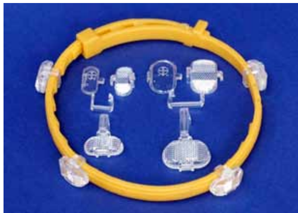
Obr. 1: Odrazky na obojky se vyrábějí ve dvou velikostech a skládají se ze tří součástí (základní destička, reflexní prvek a upevňovací třmen). Pomocí upevňovacího třmenu se odrazky kombinují téměř nerozebíratelně s obojkem. Uspořádání reflexních ploch v úhlu 60° zajišťuje, že tři až čtyři odrazky stačí k odrazení světla na všechny strany
