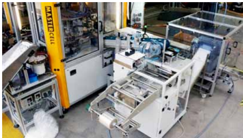
Obr. 2: Výrobní buňka pro odrazky na obojky koncipovaná společností HAHN Automation se skládá z vlastní montážní jednotky na bázi buňky HAHN MasterCell s otočným stolem a z periferních zařízení tvořených balicím zařízením a krabicového serveru pro ukládání velkých množství balení do krabic
