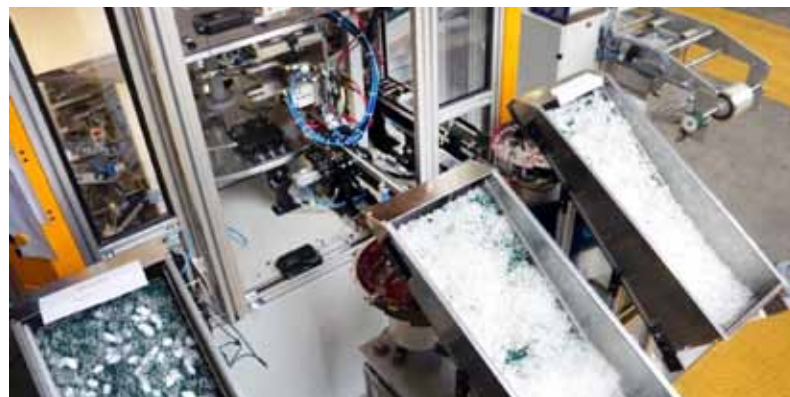
Obr. 3: Výchozím bodem pro automatickou montáž je dodání součástí ve formě sypaného materiálu. Vibrační zásobníky třídí lisované díly a přivádí je na lineární vedení k otočnému stolu
