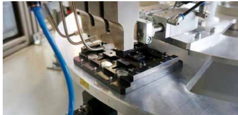
Obr. 4: Sled taktů otočného systému se šesti stanicemi začíná vložení základní destičky, do které se následně zavěsí upevňovací třmen. Po každém nasazení reflexního prvku se jednotka ultrazvukově svaří. Každý upínač dílů je koncipován pro souběžné trojnásobné zpracování a je proveden otočně. Linku je tak možné přizpůsobit různým velikostem dílů
