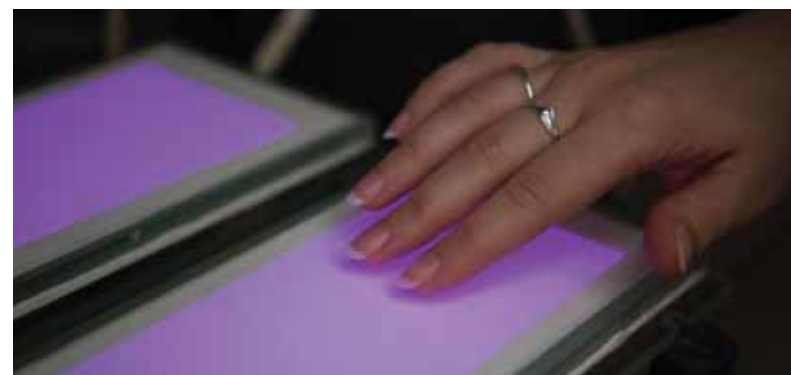
Jeden z unikátních patentovaných plazmových zdrojů vyvíjených týmem CEPLANT - difúzní koplanní povrchový bariérový výboj (DCSBD)
