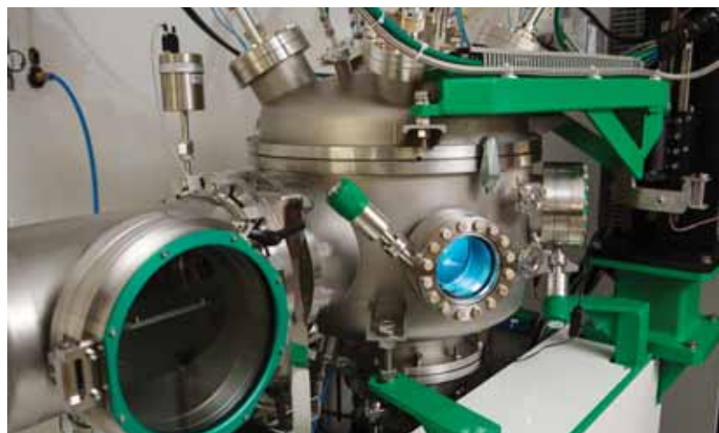
Nízkotlaký magnetronový naprašovací systém určený k vytváření nanokompozitních tenkých ochranných vrstev na površích materiálů
