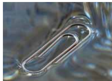
Obr. 1: Ukázka efektu povrchového napětí
