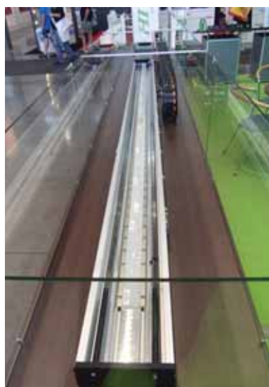
Polohovací jednotka - polohovací osa 700 × 3200 mm. Pohyblivý exponát, slouží k přesnému polohování
