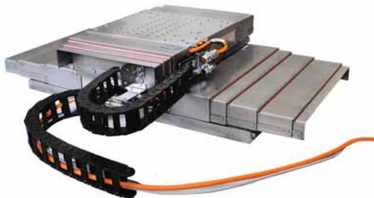
Křížový stůl X-Y 1200 × 1400 mm poháněný lineárními motory. Vhodné do pracovního prostoru obráběcích strojů. Pohyblivý exponát
