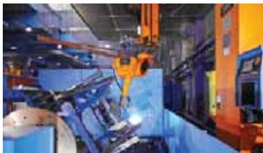
Agrostroj svařuje ve velkých sériích a stále vysoké kvalitě komponenty pro svou vlastní značku Trac-Lift pomocí většího počtu CLOOS robotických zařízení – vybavených otočnými polohovači
