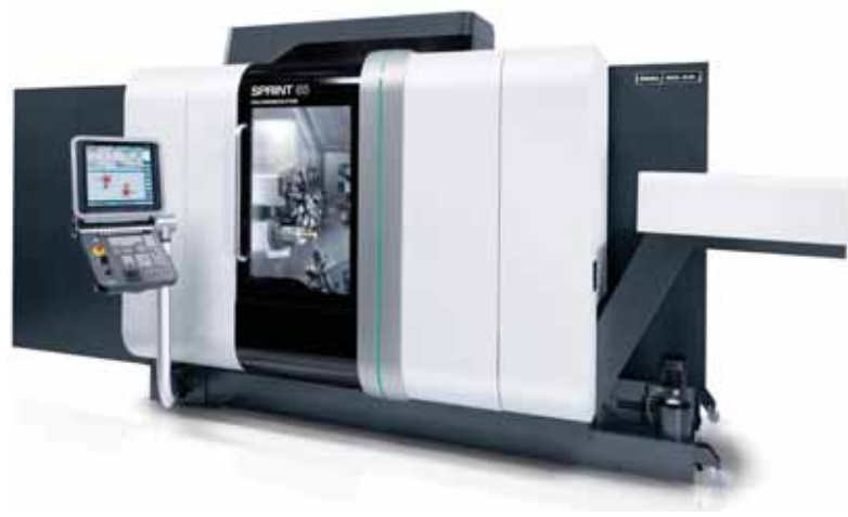
Soustružnický automat SPRINT 65 doplňuje úspěšnou řadu SPRINT. Stroj prezentovaný na veletrhu EMO je vybavený třemi revolvery, a spodní z nich je vybavený osou B, což je mezi produkčními soustružnickými automaty unikátní
