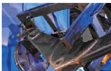
Mezi hrubou stavbou a montáží je svařovací technika rozhodujícím faktorem požadované preciznosti. Svařovací roboti CLOOS přitom zajišťují stálou přesnost svarů provedených na komponentech
