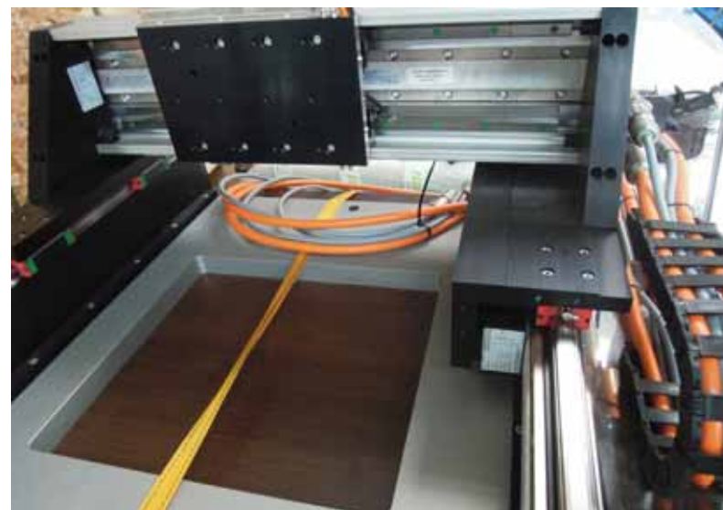
GANTRY SYSTÉM 800 × 800 mm - malé GANTRY; pohon lineárními motory. Pohyblivý exponát
