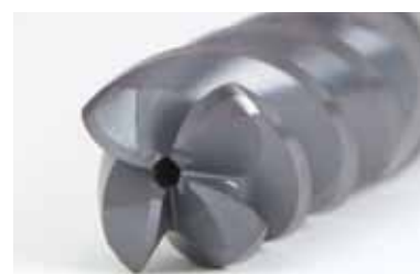
S-geometrie a axiální středový chladicí kanálek zaručuje rychlé a účinné odstranění třísek z místa řezu
