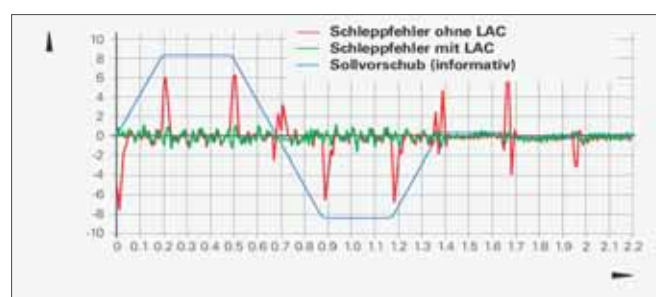
Změna zatížení - bez adaptace regulačních parametrů vlečná odchylka mimo toleranci ( \pm 0,008^\circ ) S aktivní funkcí LAC - vlečná odchylka opět v toleranci ( \pm 0,001^\circ )
