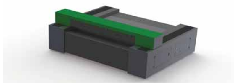
LASER - prototyp funkčního stroje, 3500 × 2600 × 1400 mm (výška), stroj pro řezání laserem + manipule s materiálem, je to stěžejní společný projekt s firmou ALT Praha
