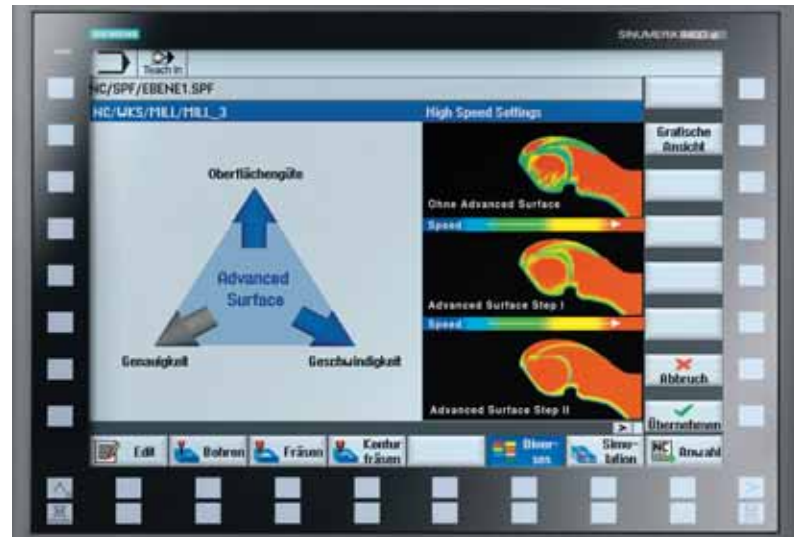
Sinumerik Operate – cyklus pro nastavení vysokorychlostního obrábění
