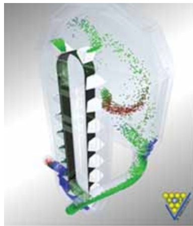
Validační model a matematický model korečkového elevátoru v DEM
