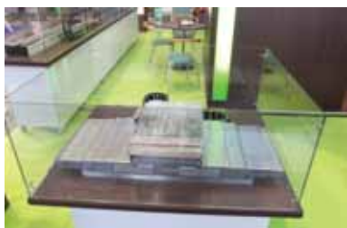
Křížový stůl XY 1200 × 1400 mm poháněný lineárními motory. Vhodné do pracovního prostoru obráběcích strojů, pohybový exponát
