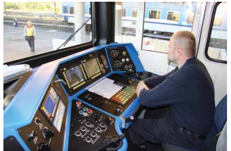
Kabina strojvedoucího vybavená AVV spolupracující s GPS
