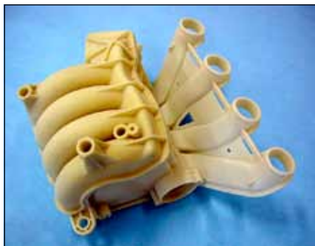
Sací potrubí spalovacího motoru z Polyamidu 12 plněného sklem
