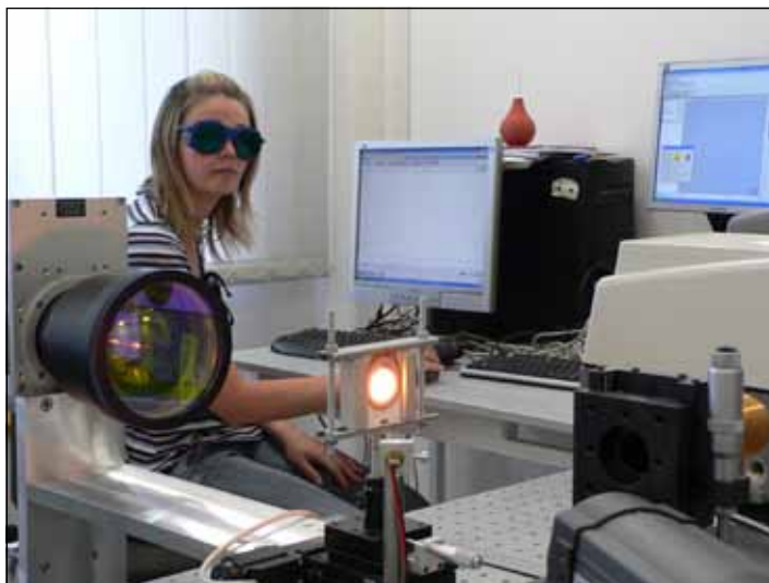
Obr. 3: Měření teplotních závislostí spektrální emisivity
