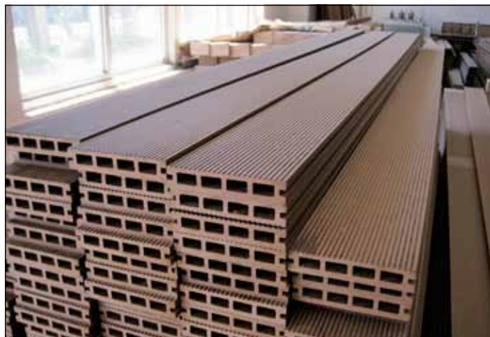
Polypropylen jako součást dřevoplastového kompozitu
