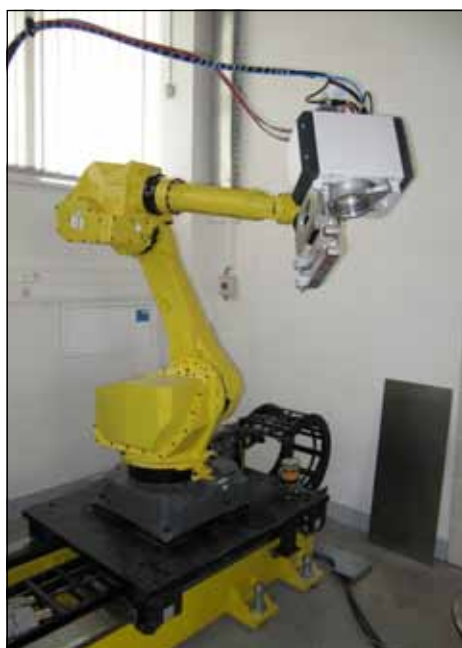
Obr. 7: Prototyp robotizovaného laserového systému pro remote aplikace
