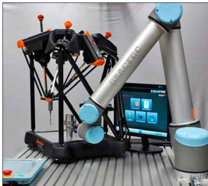
Robot UR10 zakládá díly do měřicího zařízení
