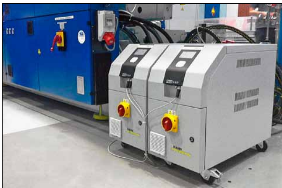
Obr. 2: Zařízení řady ProTemp-e se dodávají jako jednookruhové nebo dvouokruhové temperovací přístroje i jako nadřazené nebo podřazené jednotky, umožňují však rovněž použití v kombinaci s pokrokovou víceokruhovou temperovací technologií HAHN PulseTemp®
