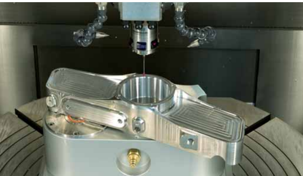
Přesné ustavení a měření obrobku dotykovou sondou HEIDENHAIN
