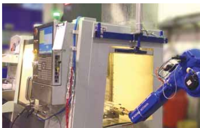
Obr. 1: Robot YASKAWA HP20D při manipulaci s polotovar a hotovými výrobky v rámci obráběcího CNC centra HAAS
