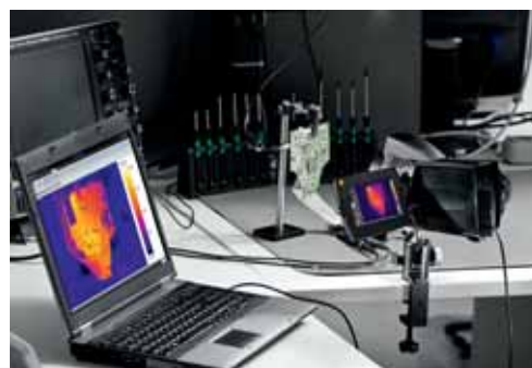
Záznam plně radiometrického videoměření probíhá do připojeného PC. V počítači je možné zvolit libovolný pixel (pixely) a zaznamenávat jeho (jejich) teplotu v čase
