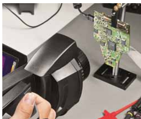
Díky minimální ostřicí vzdálenosti (10 cm) a vysokému rozlišení termokamery je možné spolehlivě měřit teplotu objektů o velikosti 0,3 mm. Lze tak měřit teplotu i těch nejmenších SMD součástek 0402
