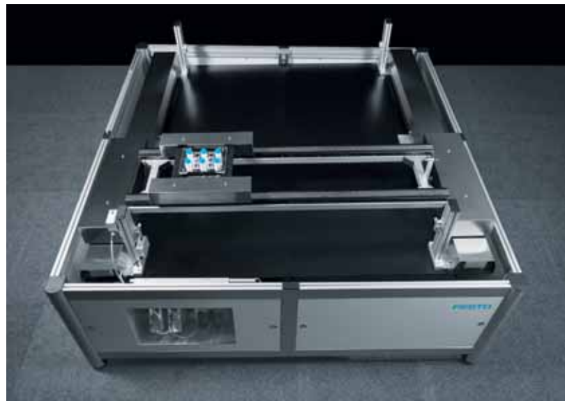
Supramanipulace: bezkontaktní pohyb bez jakéhokoliv tření
