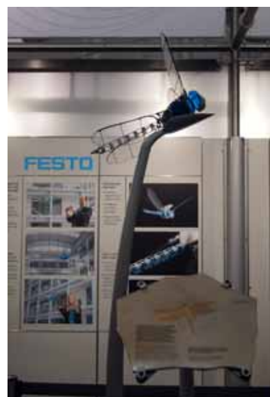
BionicOpter: robotický prototyp inspirovaný dokonalým letem vážky
