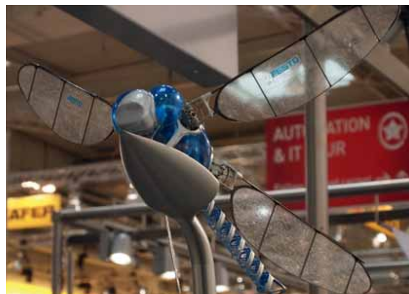
BionicOpter: robotický prototyp inspirovaný dokonalým letem vážky
