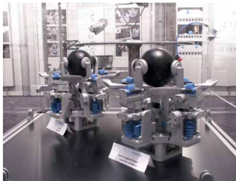
Úchopné zařízení, co se umí učit: úchopný systém schopný správné orientace kulatých objektů
