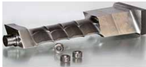
Obr. 2: Dílec z titanové slitiny obráběný rotačním frézováním
