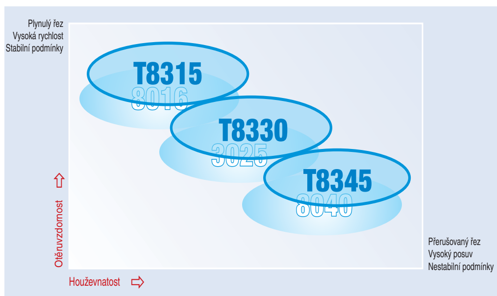
Obr. 4: Aplikační oblasti nových řezných materiálů pro soustružení
