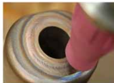
Svar vysokotlaké části hydraulického rozvodu řízení letadla HST CREATIVE pro Suchoj (Rusko)
