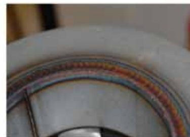
Svar příruby laděného výfukového svodu motocyklu HST CREATIVE pro Ducati (Itálie)
