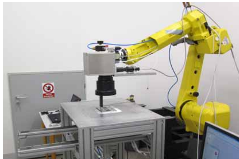
Obr. 3: Víceúčelové zařízení pro vývoj technologií laserového kvazi-simultánního svařování
