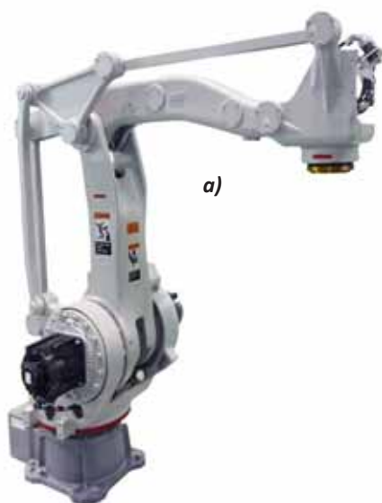
Obr. 4: Pro oblast použití PPP jsou určeny speciální, jednoúčelové roboty, např. velmi rychlý odebrací robot MPP3 založený na kinematice delta, který může pracovat při maximální rychlosti až 230 cyklů za minutu (vlevo), nebo paletizační robot MPK50
