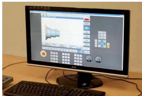
Učebna CNC programování je vybavena výukovým softwarem firmy Siemens v nejnovější verzi Sinutrain Operate
